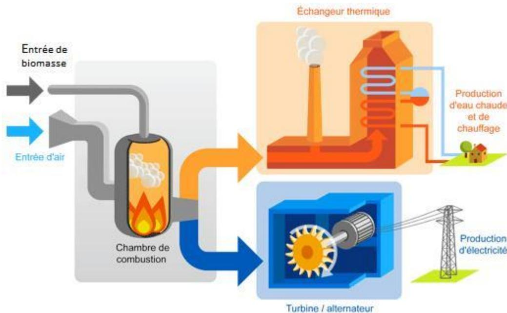
Figure 86 : Schéma de principe de la cogénération - Source : EDF
